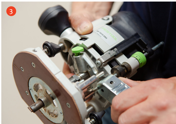
3 Freesdiepte instellen Stel de juiste freesdiepte van de sluitkommen in door de sluitkom tussen de instelschroeven te zetten.
