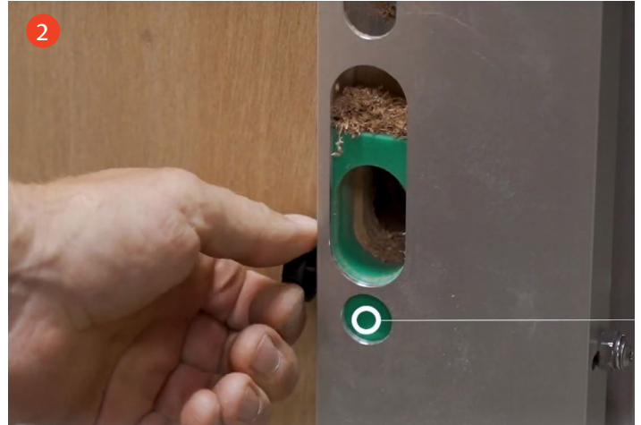
2 Frezen onderste bevestigingsgat Frees het onderste bevestigingsgat uit door het groene plaatje met het instelwiel te verplaatsen naar boven.
